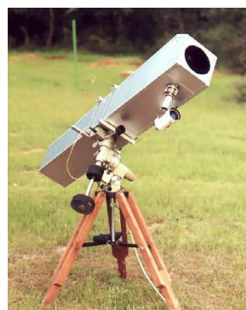
Telescopio reflector con el espejo de 150 mm fuera de eje construido por Emilio Hidalgo.
